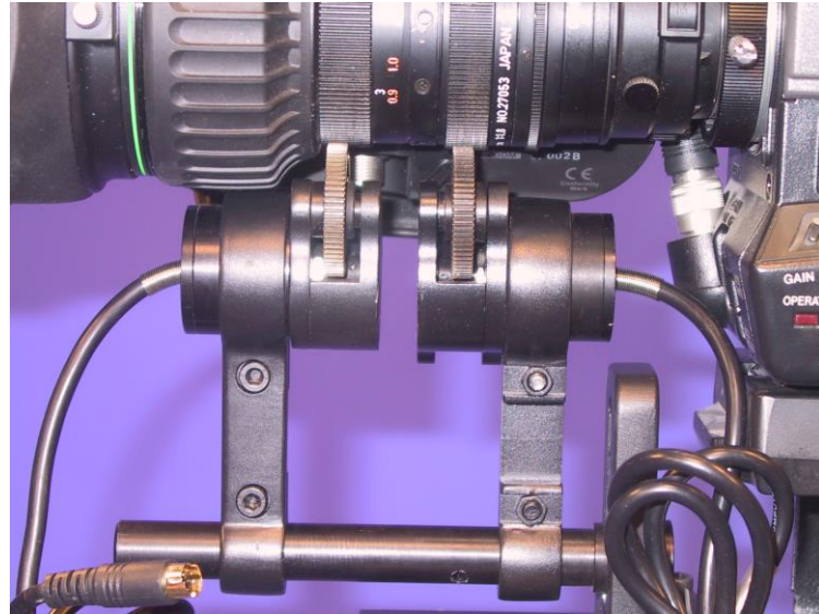
圖二：攝影機鏡頭的電子機械式追蹤系統（Zoom、Focus） （圖片來源：中科大洋使用手冊電子檔）
